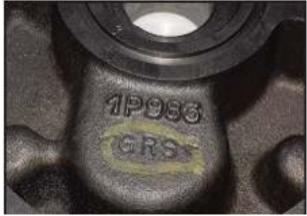
Figure 2 : Numéro de pièce non-Caterpillar
