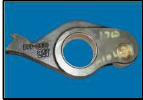
Figure 4 Pièce forgée brisée
