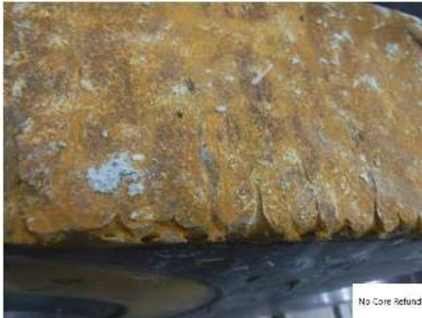
Figure 2 - La surface du maillon a été soudée. Il s'agit d'un exemple de tentative de récupération infructueuse, qui ne donne pas lieu à un remboursement de noyau.
