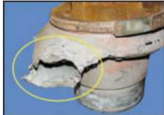
Figure 4 : Turbocompresseur endommagé par le feu
