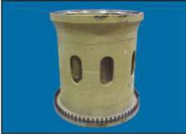
Figure 1 : Dommages à la bride
