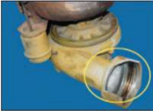
Figure 3 : Boîtier brisé à la suite d'une mauvaise manipulation
