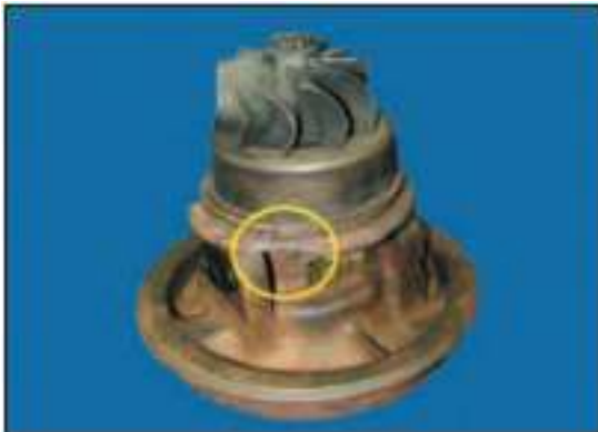
Figure 5 : Dommages non opérationnels - boîtier brisé
