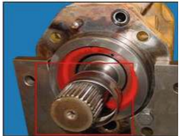
Figure 4 : Défaillance du palier d'arbre
