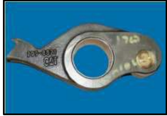
Figure 4 Pièce forgée brisée
