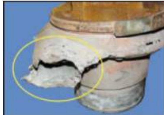
Figure 4 : Turbocompresseur endommagé par le feu
