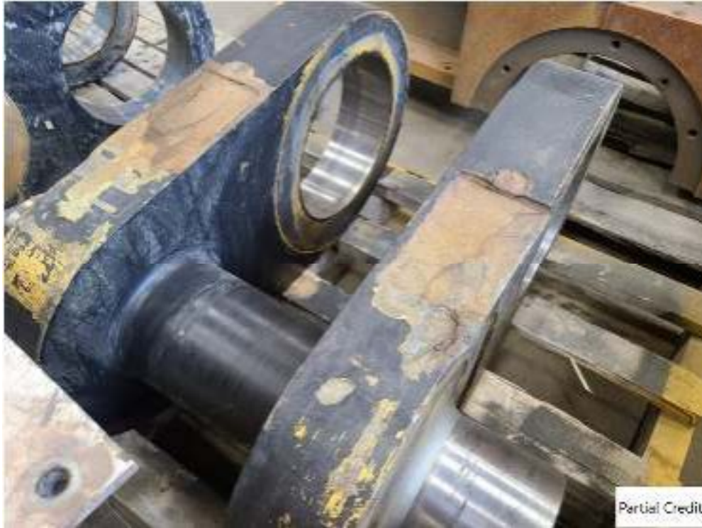
Figure 1 - Il y a des traces de piqûres derrière la surface d'usure normale du maillon. Cela serait considéré comme un dommage opérationnel et donnerait lieu à un crédit partiel.
