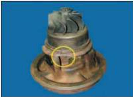
Figure 5 : Dommages non opérationnels - boîtier brisé
