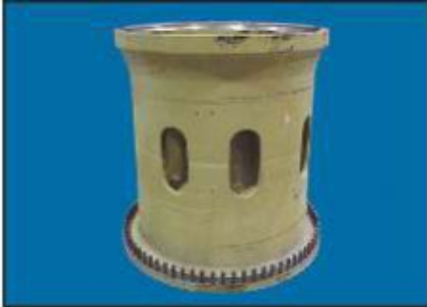
Figure 1 : Dommages à la bride
