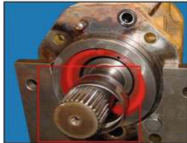
Figure 4 : Défaillance du palier d'arbre
